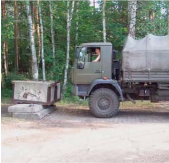
Rys. 2. Stanowisko pomiarowe – uderzenie samochodu Star 944 w blok betonowy o masie 6000 kg (2a) i przykład wyników – przyspieszenie wzdłużne w funkcji czasu, dla prędkości uderzenia 8 km/h (2b)
