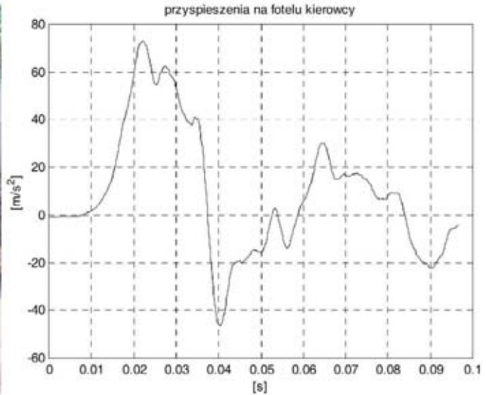
Rys. 2. Stanowisko pomiarowe – uderzenie samochodu Star 944 w blok betonowy o masie 6000 kg (2a) i przykład wyników – przyspieszenie wzdłużne w funkcji czasu, dla prędkości uderzenia 8 km/h (2b)
