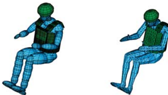
Rys. 6. Modele 95-cyntylowego manekina/człowieka uzupełnione o kamizelkę kuloodporną i hełm Fig. 6. Models of the 95-% dummy/human supplied with bullet-proof jackets and helmets
